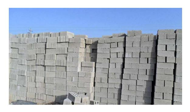
多孔砖在建材行业的使用,还是非常重要且广的。多孔砖是指用黏土、粉煤以及页岩为主要的原料,经过成型和焙烧而成的,空洞率一般是不能低于 百分之十五到百分之三十的。多孔砖的孔型一般是圆孔或者非圆孔的,孔的数量多且尺寸小。多孔砖的主要用途是用于砖混结构的承重部位。那么。我们就来了解下多孔砖的特点以及使用范围吧。
